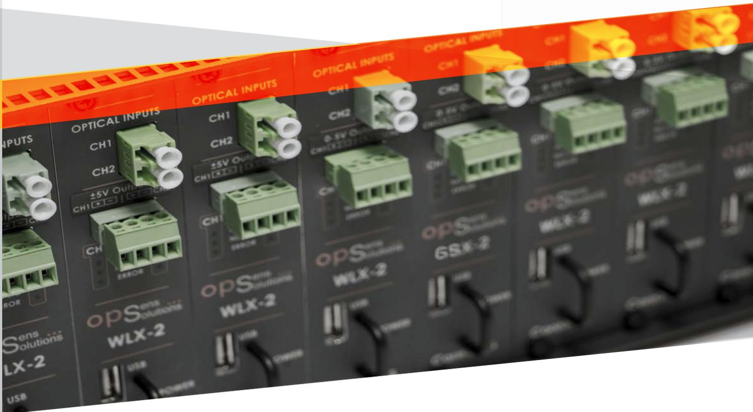
Opsens Solutions에서 개발한, 정확하고 사용자의 니즈에 맞게 조정된 CoreSens의 차세대 신호 처리기는 다수의 측정 채널에 걸쳐 확정적 동기화를 통한 고속 측정을 제공합니다. EtherCAT® 인터페이스를 통해 여러 CoreSens 장치는 단일 측정 시스템으로 그룹화되어 최대 1,300개의 측정 채널을 제공합니다.
