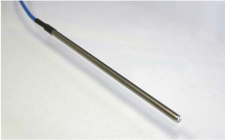
까다로운 애플리케이션 및 거칠게 다루지는 사용을 위한 GaAs 기반 광섬유 온도 센서
